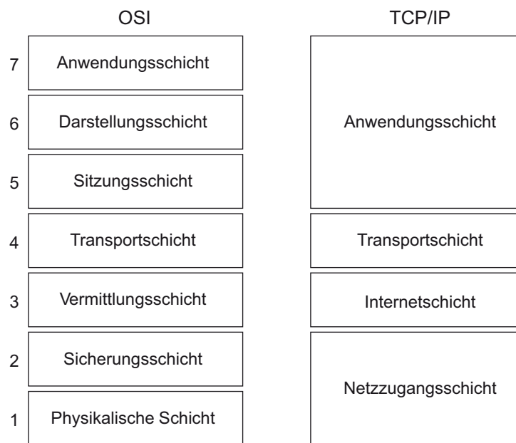
Abb. 3.5: TCP/IP im Vergleich zum OSI-Referenzmodell
