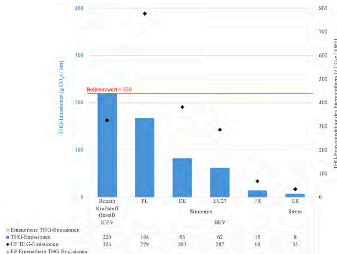
Abbildung 15: THG-Emissionen eines batterieelektrischen Fahrzeugs (BEV) bei Verwendung von landesspezifischem Strommix oder erneuerbaren Energien
