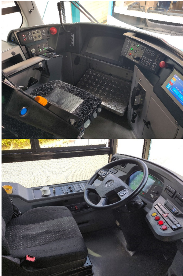
Abbildung 4 – Fahrer:innenarbeitsplatz Straßenbahn (Chemnitz, D) mit Sollwertgeber (links) und Bus (Chemnitz, D) mit Lenkrad (rechts)
