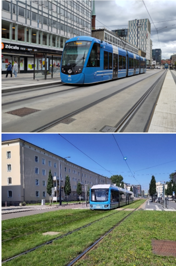
Abbildung 3 - Straßenbahnen sind spurgeführte Schienenbahnen auf straßenbündigen und besonderen|unabhängigen Bahnkörpern, hier: Straßenbahn in Stockholm (SE) und Chemnitz (D)
