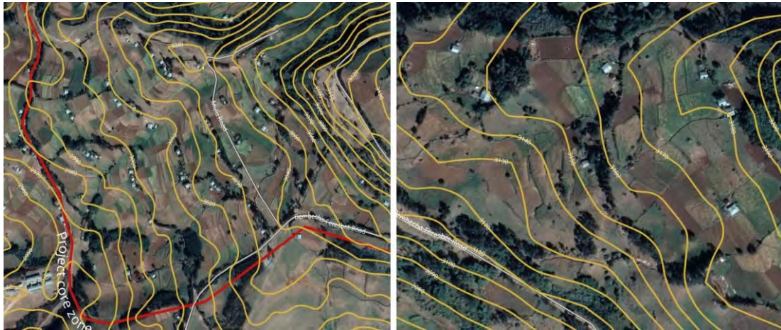
Abbildung 20: Vergleich von Konturlinien und aktuellen Feldgrenzen zur Analyse der Bewässerungseffizienz. Hauptanbaugesamt von Addis Alem links und von Amistija rechts. Quelle: Eigene Darstellung basierend auf Nasa Earth Data.
