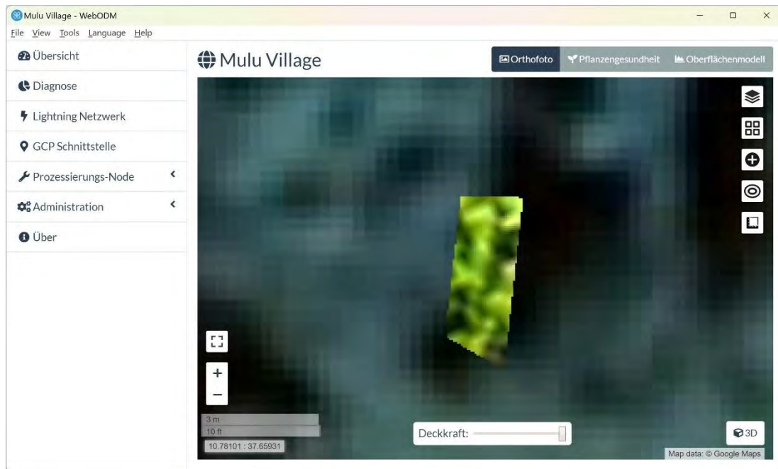
Abbildung 12: Ein unzulängliches Orthofoto generiert aus etwa 40 Drohnenaufnahmen. Quelle: Eigener Screenshot der WebODM Desktop-Anwendung.
