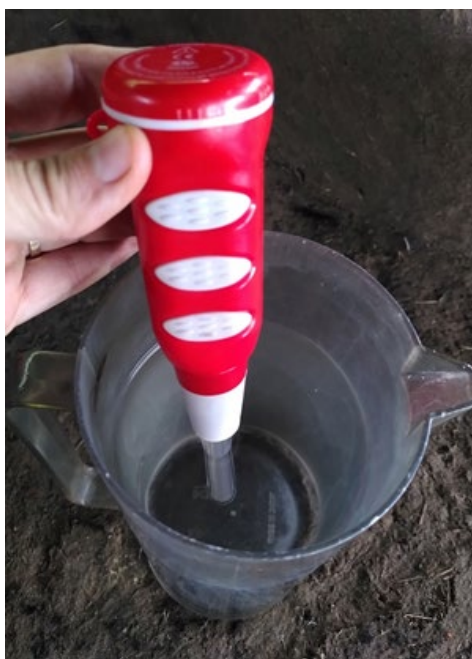
Abbildung 4 Wasserdeshinfektion via UV-Strahlung (Quelle: Eigenes Foto)
