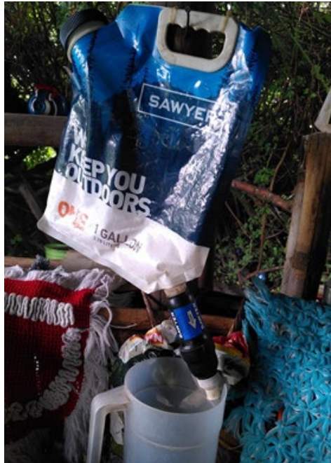
Abbildung 5 Mikro-filtration mit Gravitation als Treiber (Quelle: Eigenes Foto)
