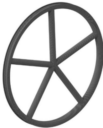
Abbildung 19 Prinzipdarstellung des zu berechnenden 5-Speichen-Laufrads aus Faserverbund-kunststoff [Eigene Darstellung]
