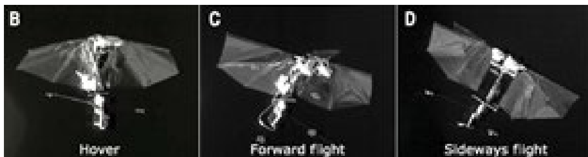
Abbildung 20 Neigung der Mikrodrohne beim Schwebflug, Vorwärtsflug und Seitwärtsflug [KAR18]
